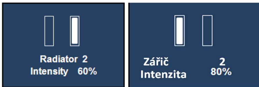
Obr. 5: Displej s jednoživatelským ovládáním v kabině určené pro dvě osoby (zářič č. 2 je aktivní)
